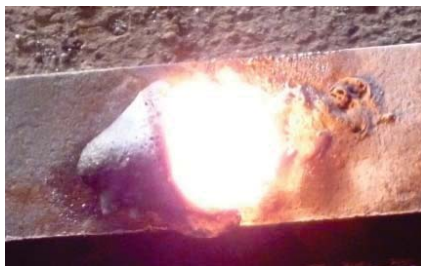
Рисунок 2 – СВС-процес формування композиційного матеріалу 70% ( Ti+C+Fe_2O_3+Al ) + 20% ПГ-10Н-01 + 10% ПТ-НА-01
