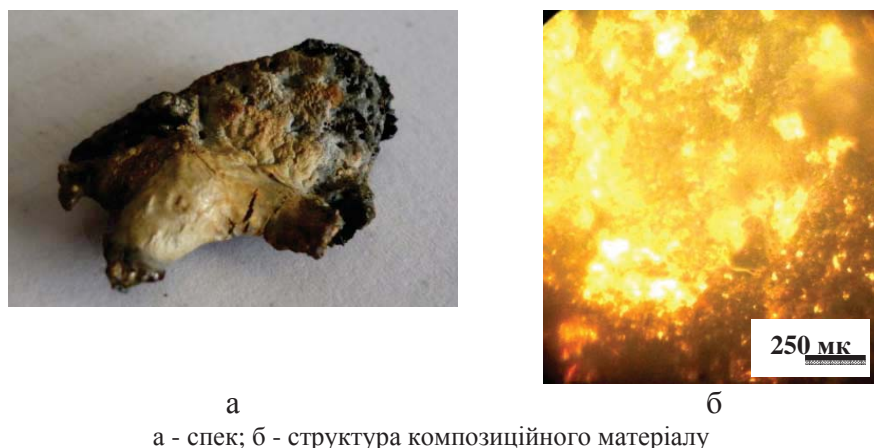
Рисунок 3 – Композиційний матеріал 70% (Ti+C+Fe 2 O 3 +Al) + 20% ПГ-10Н-01 + 10% ПТ-НА-01 після СВС-процесу
