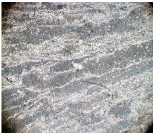
Рисунок 3 – Микроструктура зоны наплавленного слоя без ввода модификаторов x1000
