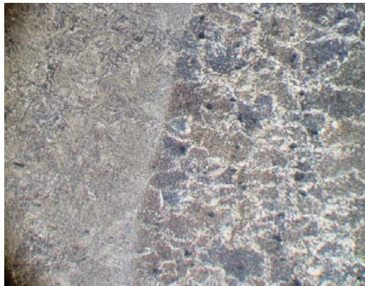
Рисунок 4 – Граница раздела при наплавке с добавками
