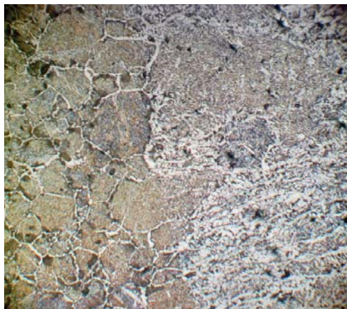
Рисунок 3 – Микроструктура зоны наплавленного слоя без ввода модификаторов x1000
