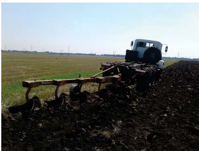
Рисунок 2 – Орний агрегат МЕЗ-330 + плуг ПНН-5-40
