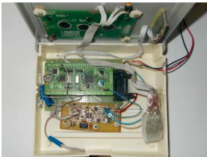
Рисунок 3 – Компоненти електронної частини АПК вимірювання вологості зерна в потоці Джерело: розроблено авторами
