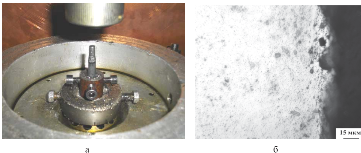
а – обробка твердосплавної заготовки пуансона на електроерозійному верстаті моделі "Дуга-8Г" графітовим ЕІ ( I = 125 \text{ А} , P_{cm} = 1,5 \text{ МПа} , F = 46 \text{ мм}^2 , U = 25 \text{ В} ); б – мікроструктура (x500) поверхневого шару сплаву ВК8 після РОД бічної поверхні зразка графітовим ЕІ ( I = 125 \text{ А} , P_{cm} = 1,5 \text{ МПа} , F = 46 \text{ мм}^2 , U = 25 \text{ В} )
