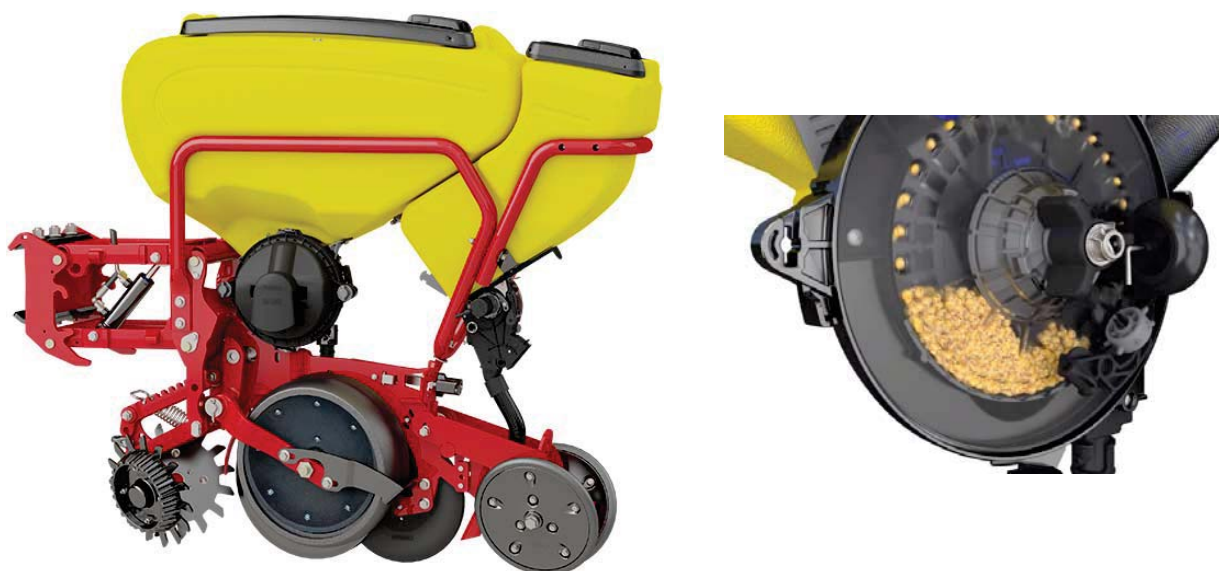
Рисунок 4 – Загальний вигляд посівної секції та висівного апарату сівалки Tempo T компанії Väderstad
