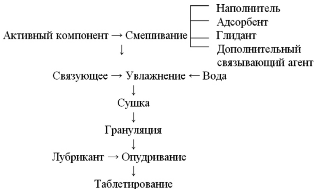
Рис. 1. Общая схема технологического процесса.
