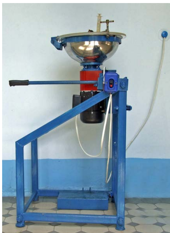
Рис. 2. Схема макетного зразка пристрою для протруювання насіння: 1 – рама; 2 – робоча камера; 3 – відкидна кришка; 4 – електродвигун; 5 – вертикальний вал; 6 – тарілчастий диск; 7 – диск-розприскувач; 8 – лопаті-ворушилки; 9 – ємність-дозатор; 10 – важіль; 11 – пускач.
