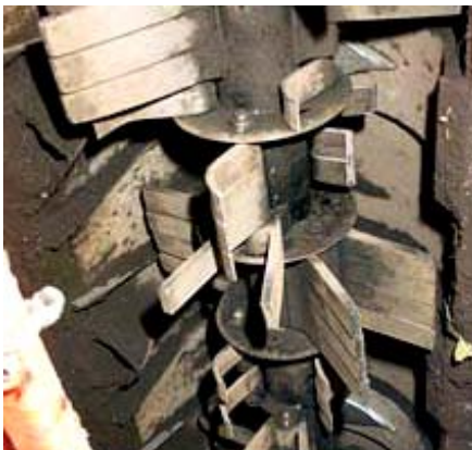
Рис. 3: а – робочі органи для відокремлення гички; б – котки для вдавлювання подрібненої гички в ґрунт.
