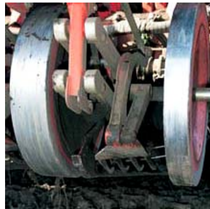
Рис. 3: а – робочі органи для відокремлення гички; б – котки для вдавлювання подрібненої гички в ґрунт.
