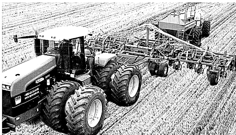
Рис. 3. Широкозахватний комплекс АТД 11.35 для прямої сівби з одночасним внесенням мінеральних добрив.
