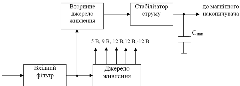
Рис. 2. Функціональна схема джерела живлення імпульсного генератора
