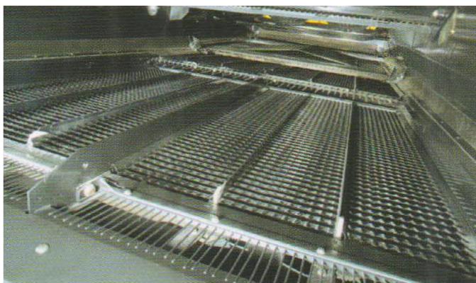
Рис. 11. Очистка Opti-Clean зернозбиральних комбайнів CR9080, CR8070 і CR8080: а – компенсація бокового нахилу до 17%; б – регулювання решіт з місця оператора
