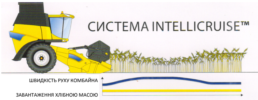
Рис. 7. Система автоматичного регулювання подачі хлібної маси IntelliCruise
