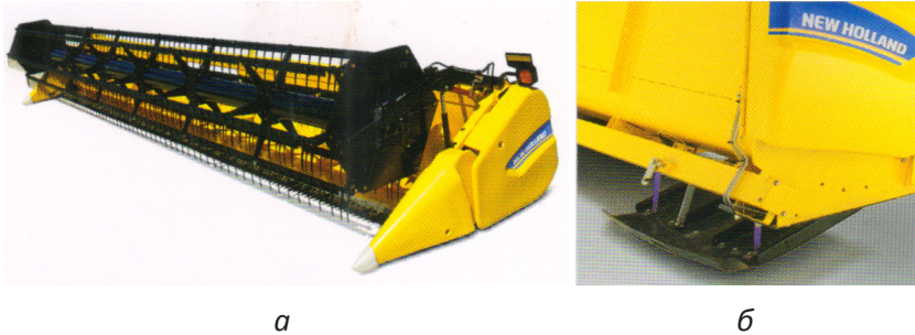
Рис. 4. Жатка SuperFlex (а) і автоматичне регулювання висоти жатки (б)
