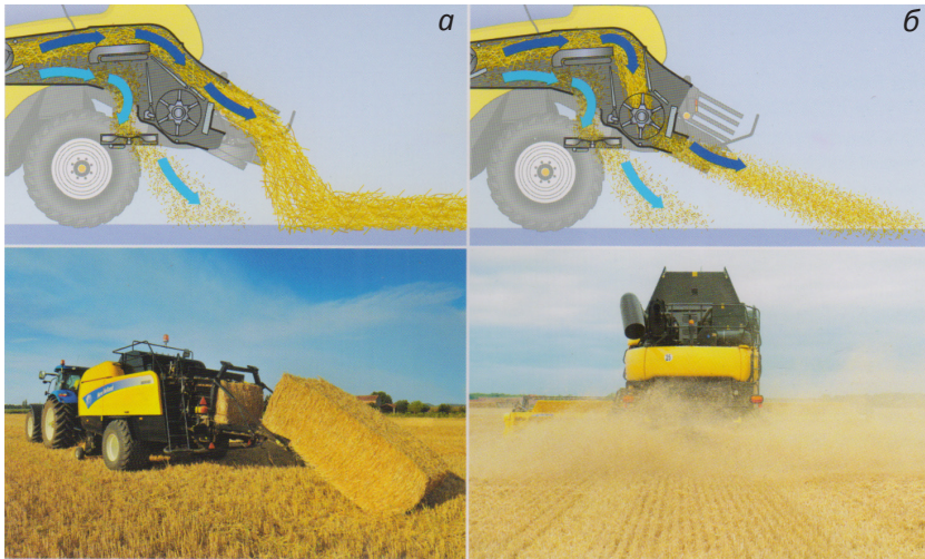
Рис. 12. Способи збирання незернової частини урожаю: а – укладання соломи у валок для подальшого підбирання і пресування; б – подрібнення і розкидання соломи на ширину захвату жатки
