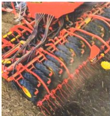
Рис. 8. Система OffSet – розміщення коліс прикочуючої частини в шаховій послідовності зі зміщенням на 190 мм і закріплення на індивідуальних осях
