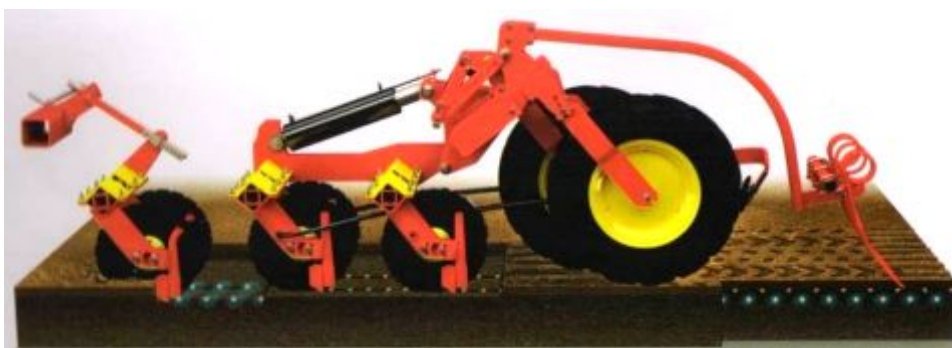
Рис. 6. Система контролю глибини загортання насіння
