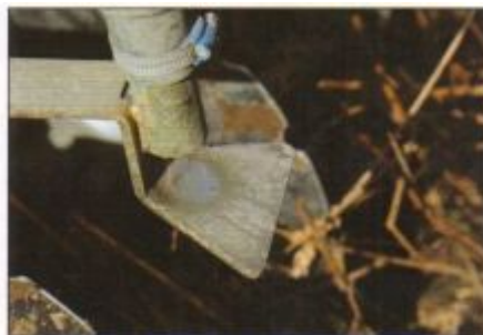
Рис. 9. Технологічна схема сівалки Rapid, обладнаної міні-сівалкою BioDrill (а) та випускний штуцер з пластиною розподільника насіння (б)
