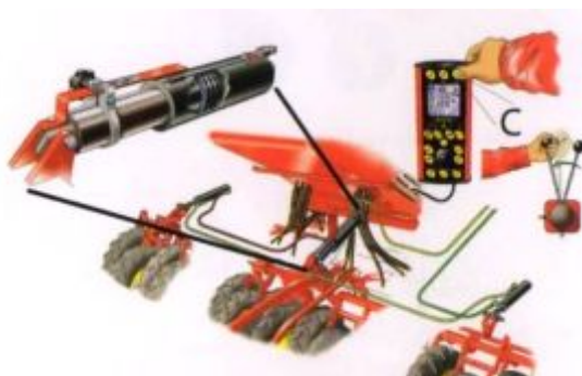
Рис. 7. Активації налаштування глибини загортання насіння та її задання
