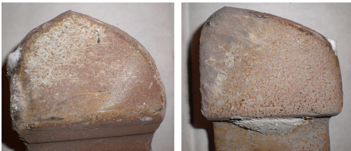
Рисунок 2 – Вид изношенных накладных головок из термообработанной Ст50Г2
