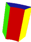
б) цилиндрические координаты ( \Delta h = 0,09 м, \Delta r = 0,05 м, \Delta \varphi = 45^\circ )
