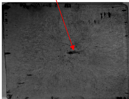
Рисунок 5 – Макроструктура металу безперервнолитої заготовки 150 сталі марки СтЗнс пл. 254610 (№ 5)
