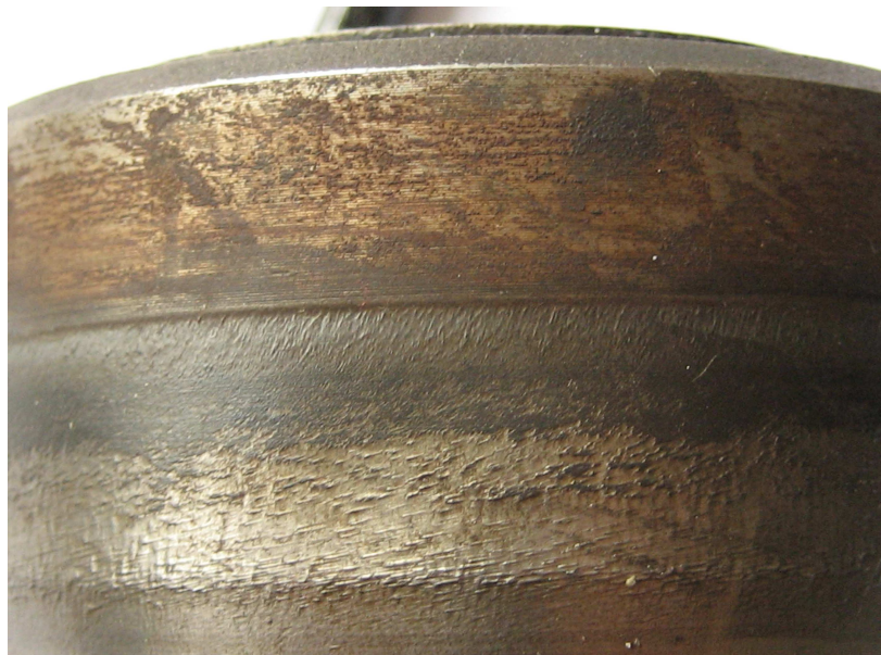
Рисунок 4 – Износ рабочей части вала из стали ДИ-22
