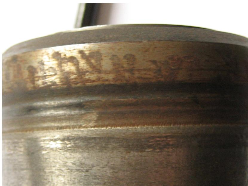
Рисунок 3 – Износ рабочей части вала из стали У7
