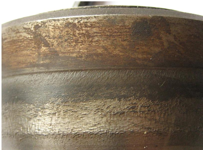
Рисунок 4 – Износ рабочей части вала из стали ДИ-22
