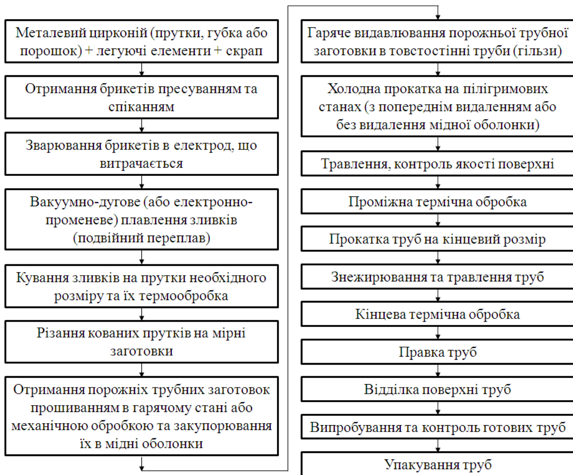
Рисунок 1 – Схема виробництва труб з цирконієвих сплавів
