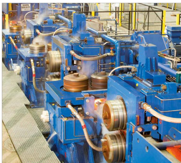
Рисунок 6 – Чорнова група клітей з консольними валками конструкції SMS-Meer [16]
