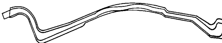
Рисунок 10 – Чистой и предчистой шаблоны при прокатке обода с «раскатной волной»
