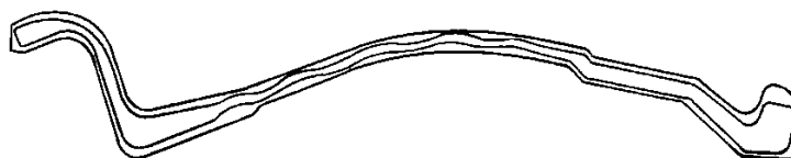
Рисунок 9 – Чистой и предчистой шаблоны при прокатке обода с центральной волнообразной частью
