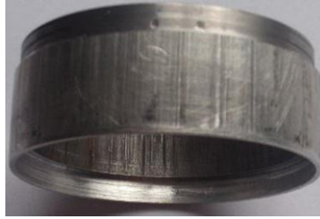
Рисунок 7 – Экспериментальный образец биметаллического трубчатого элемента
