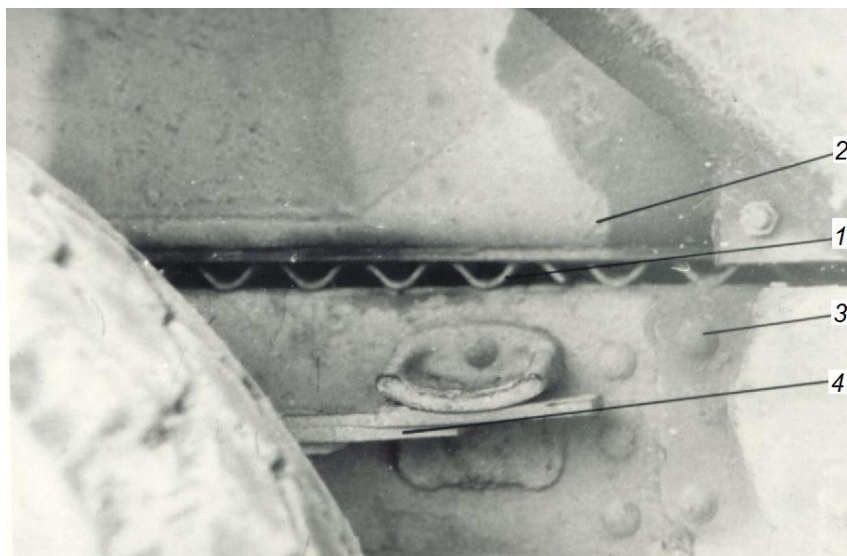
Рисунок 5 – Розташування хвилявидної оболонки 1 між лонжеронами обв'язувальної рами 2 та рами автомобіля 3, 4 – ресорна підвіска шасі автомобіля МАЗ-5550С3
