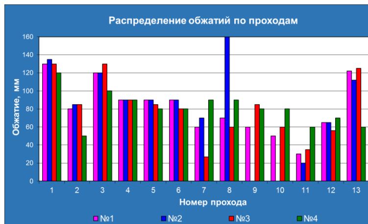
Рисунок 3 – Распределение обжатий по проходам для существующих режимов № 1–4
