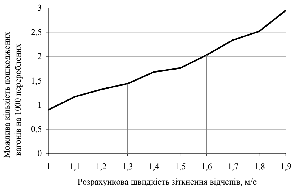
Рис. 1. Крива залежності можливої кількості пошкоджених вагонів від розрахункової швидкості зіткнення відцепів на сортувальних коліях
