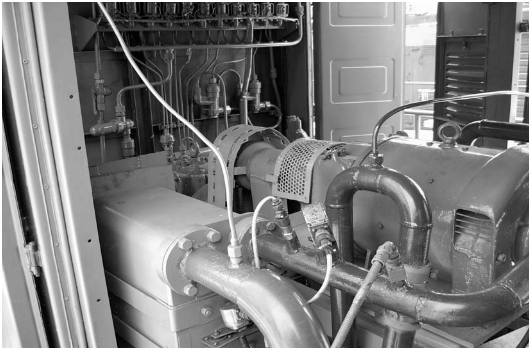
Рис. 2. Забудова гідропередачі Voith L5r4 U2a та теплообмінника в модернізованому локомотиві ТГМ6
