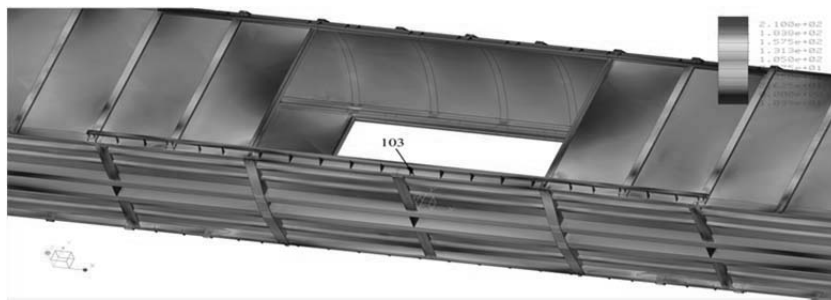
Рис. 3. Напряженно-деформированное состояние вагона крытого по III режиму - растяжение. Боковая балка у дверного проема с усилением из листа 8 мм на длине 5500 мм
