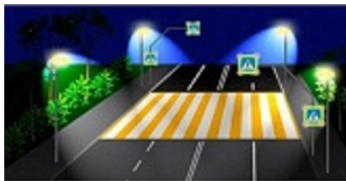
Рис. 9. Автономна система освітлення пішохідного переходу з датчиком руху
