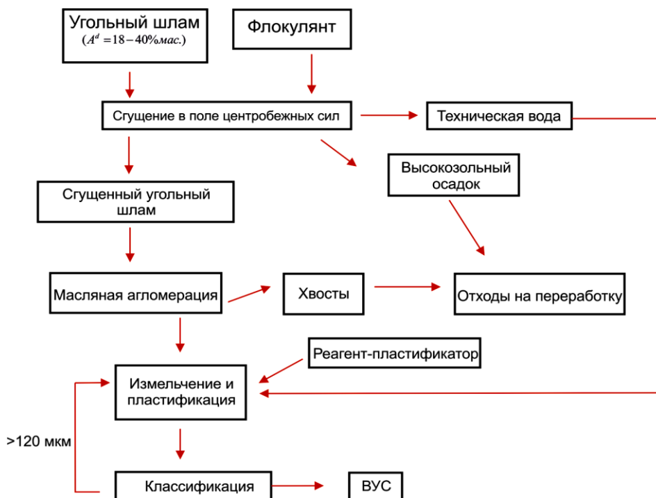
Рис. 1. Схема получения ВУТ на основе угольных шламов
