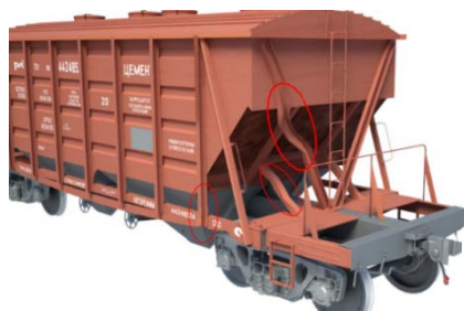
в) Погнуті і пошкоджені стійки і розкоси
