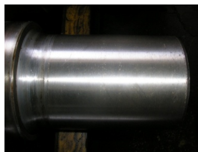
Рис. 6. Шийка осі колісної пари після накатування та шліфування
