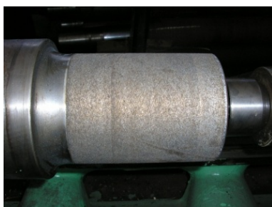
Рис. 5. Відновлена шийка осі колісної пари
