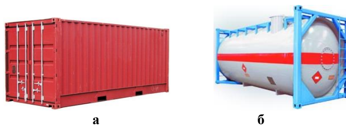
Рис. 2. Загальний вигляд контейнера: а – універсальний; б – контейнер-цистерна
