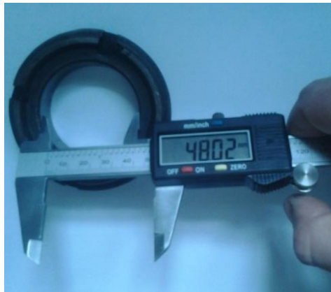
Рис. 3. Вимір внутрішнього діаметра напрямної цифровим штангенциркулем
