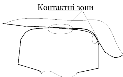
Рис. 2. Одноточковий контакт у зоні робочої грані рейки
