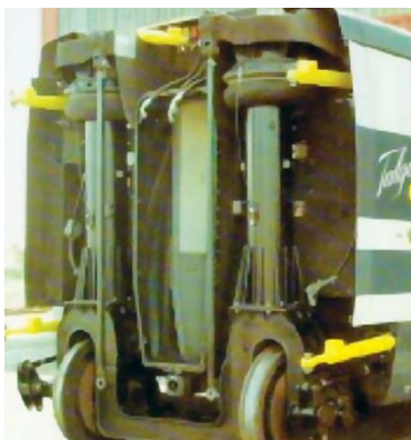
Рис. 6. Система пневматичного підвішування високошвидкісного поїзда AVE S103
