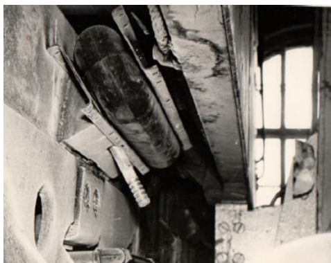
Рис. 8. Пневматичний елемент НИ-14 на електровозі ВЛ60
