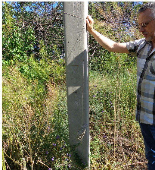
Рис.3. Наклоны земной поверхности в зоне плавных сдвижений
