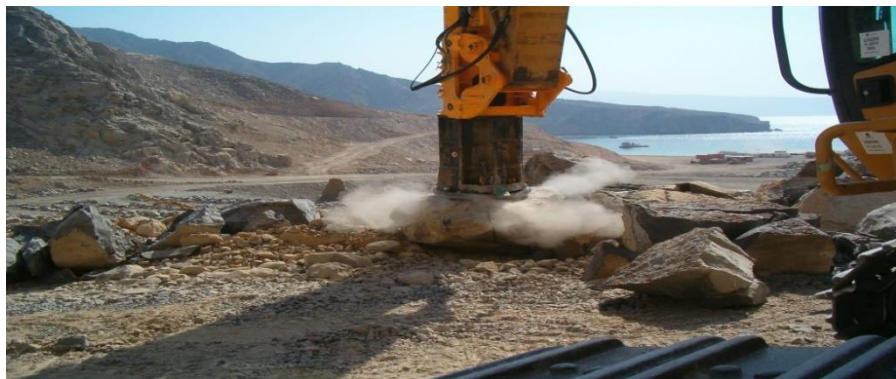
Рис. 4. Пример применение кинетического молота Fractum
