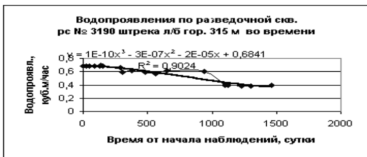
Рис. 8. Водопроявления по разведочной скважине №3190 штрека л/б гор. 315 м во времени
