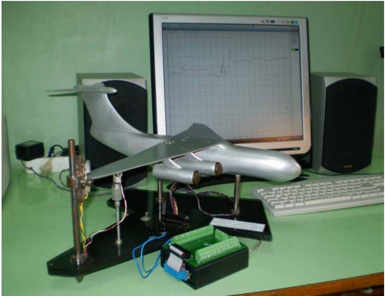
Рис. 1. Установка для збудження резонансних коливань крила
