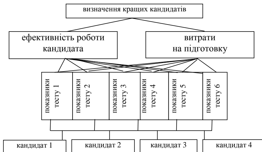
Рис. 2. Структурна схема вибору кращих кандидатів методом аналізу ієрархій
