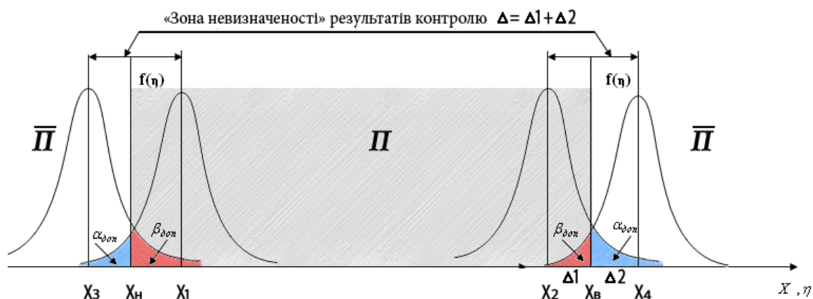
Рис. 2. Зони невизначеності на межах допуску (помилки I і II роду): X_n, X_v – граничні значення (нижнє і верхнє) параметрів, які контролюються; X_1, X_2, X_3, X_4 – дійсні значення параметрів, які контролюються; \eta, f(\eta) – похибка контролю та щільність її розподілу; a_{\text{дон}}, b_{\text{дон}} – гранично допустимі значення помилок I та II роду.
