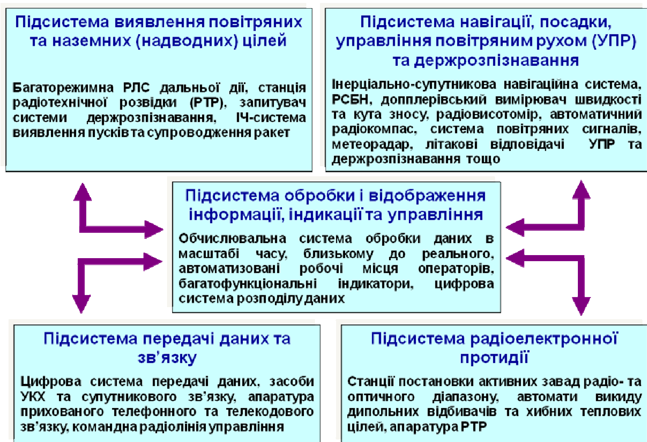
Рис. 1. Структурна схема та зв'язки БРЕО сучасного літака ДРЛВУ
