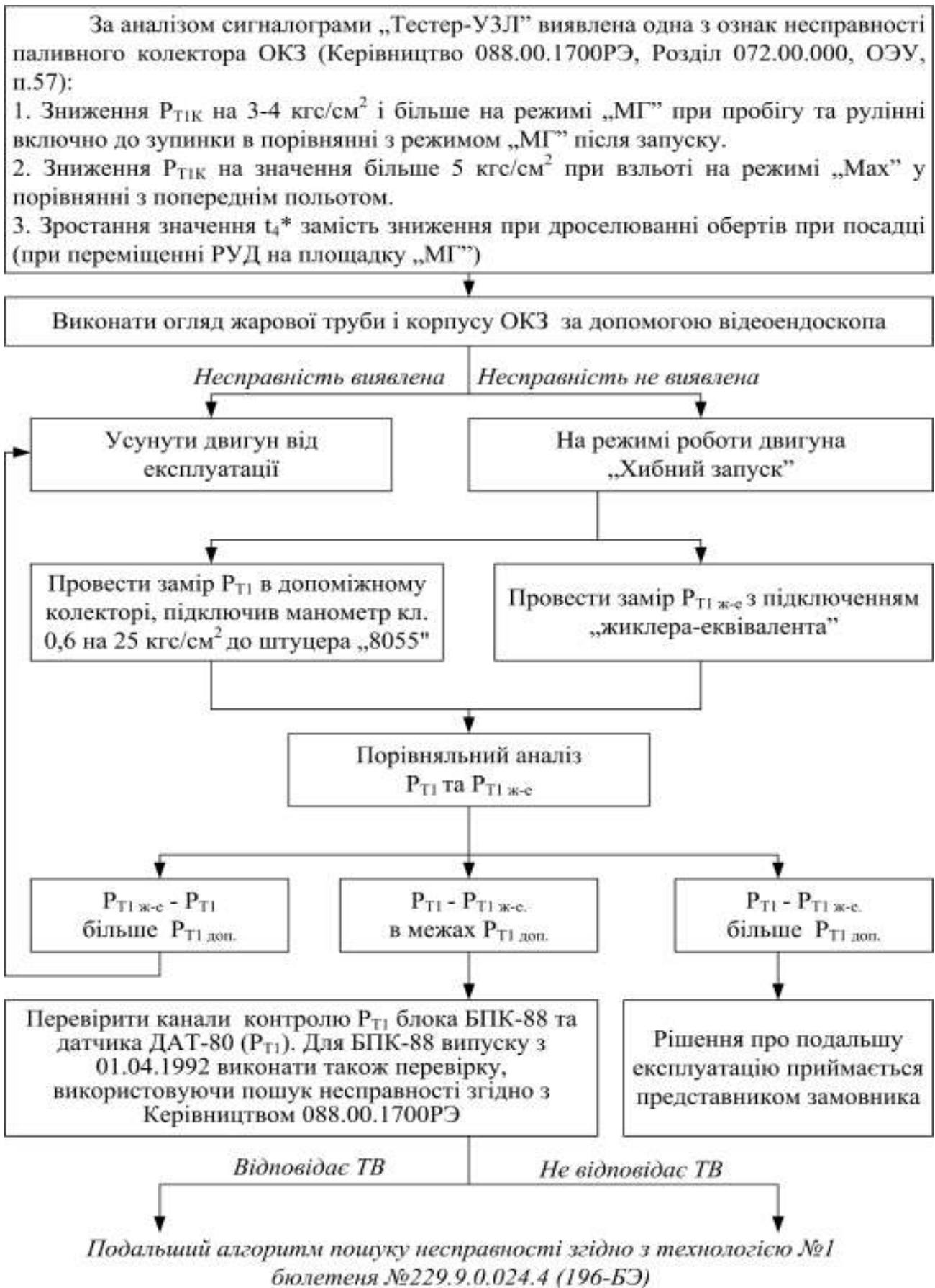
Рис. 4. Алгоритм оцінки технічного стану паливного колектора ОКЗ АД РД-33
