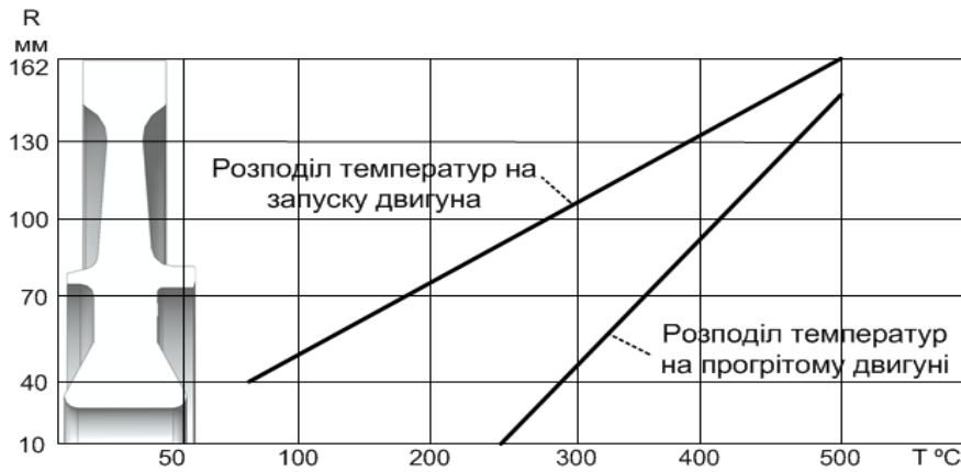
Рис. 2. Розподіл температури в матеріалі диска турбіни РУ19А-300
