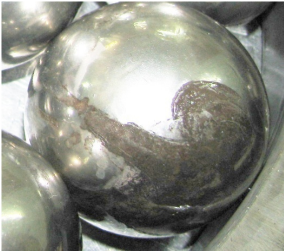
Рис. 3. Руйнування підшипників опор редуктора
