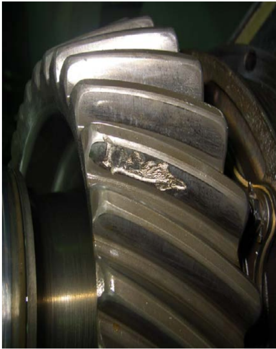
Рис. 1. Контактні руйнування зубців, обумовлені концентрацією навантаження
