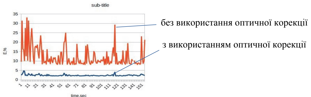
Рис.2. Відображення показань точності при польоті по заданій дистанції з використанням системи орієнтації з контуром оптичної корекції
