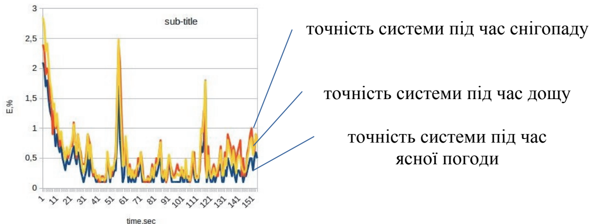
Рис.1. Відображення показань точності при польоті по заданій дистанції без використання системи орієнтації з контуром оптичної корекції
