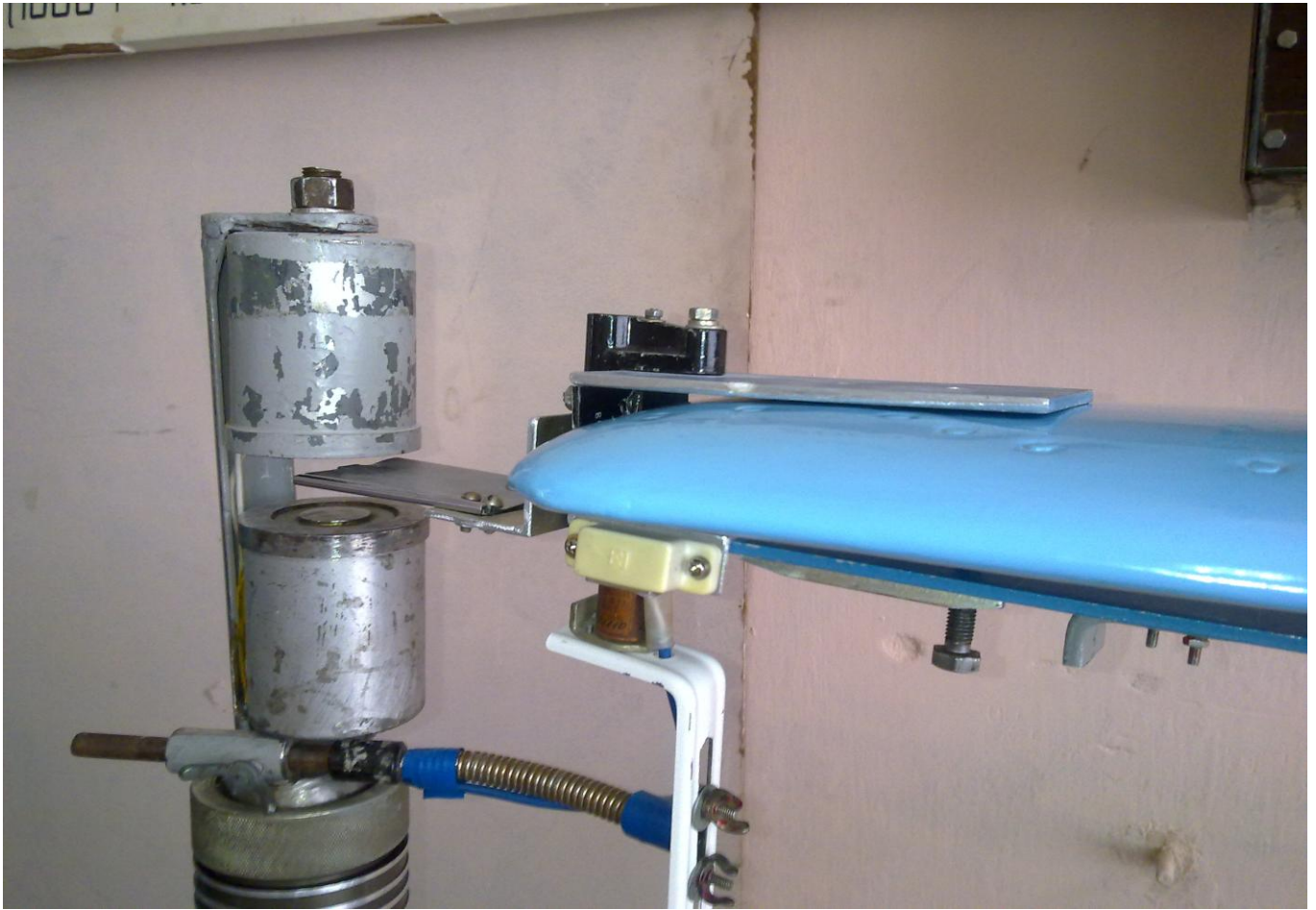
Рис.2. Розміщення феритової пластини та магніту датчика на макеті крила
