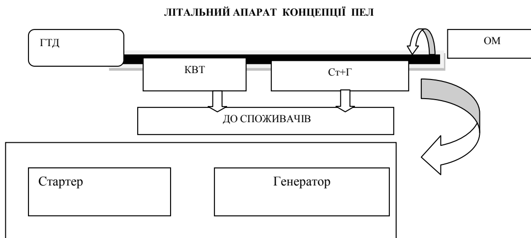
Рис.1. Схема запуску газотурбінних двигунів та генерації електроенергії з використанням концепції ПЕЛ: КВТ – компресор високого тиску, Ст+Г – стартер плюс генератор, ОМ – обертаючий момент.
