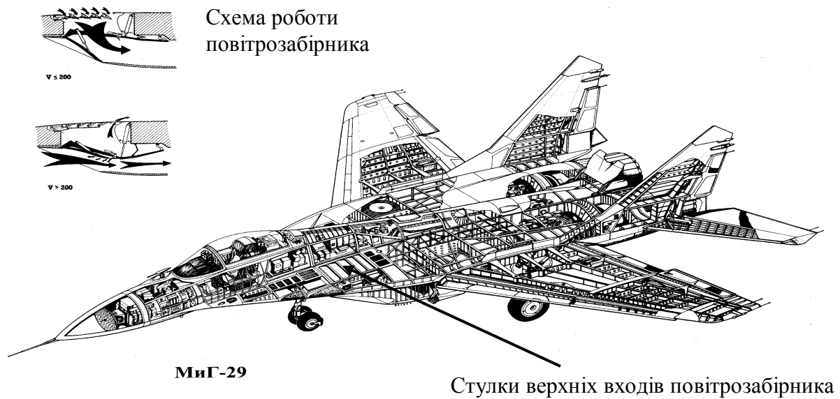
Рис. 1 Місце розміщення на планері літака МиГ-29 ступок верхніх входів повітрозабірника та схема роботи повітрозабірника
