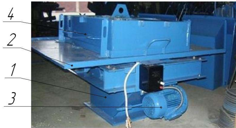
Рисунок 1 – Ударно-струшувальна установка УА-6: 1 – нерухома рама; 2 – рухома рама; 3 – електродвигун; 4 – форма
